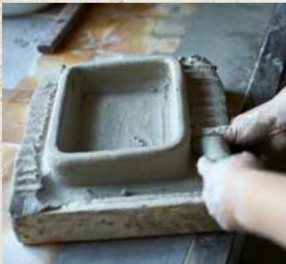
⚡ Der Kachelrumpf wird auf die Rückseite des Kachelblatts aufgelegt. Damit es eben ist, wird es mit einer flachen Kachel angedrückt.
