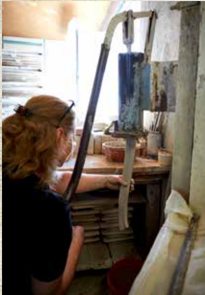
⚡ Das Profil des Kachelrumpfs kommt aus der Presse. Die »Wurst« aus Schamott und Ton ist da.
