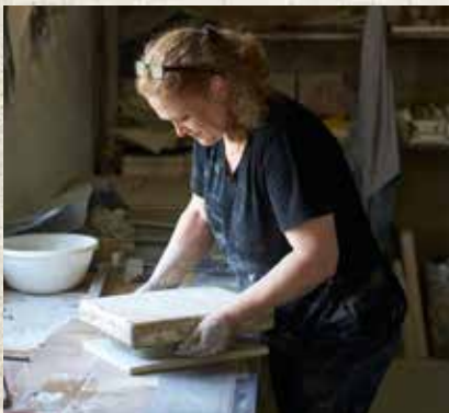
⚡ Nun wird die Form nach oben abgezogen. Möglicherweise muss leicht geklopft werden.
