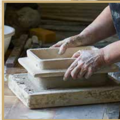
⚡ Der Rumpf wird von außen und innen mit Kachelmasse angedrückt und so am Blatt angeheftet.
