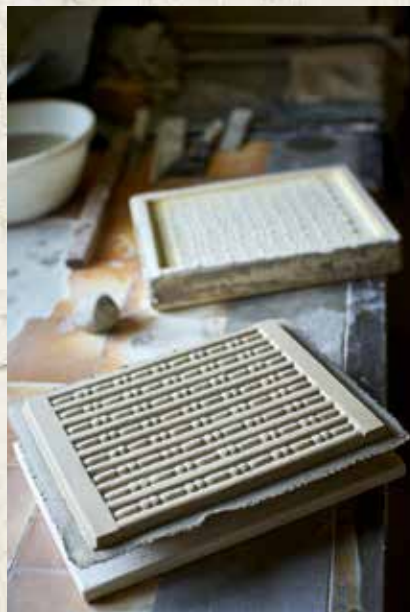
Die Kachel vor der Fein-Endbearbeitung, also vor der Entfernung vorhandener Unebenheiten. ⚡
