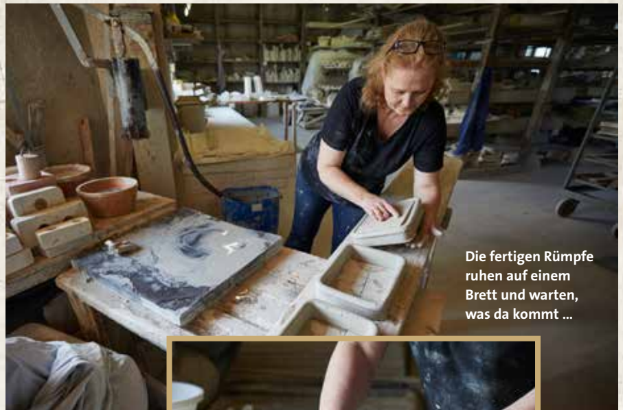
Der Ton für das Kachelblatt wird in die entsprechende Form gedrückt – und zwar so, dass keine Luftbasen übrigbleiben. ⚡
